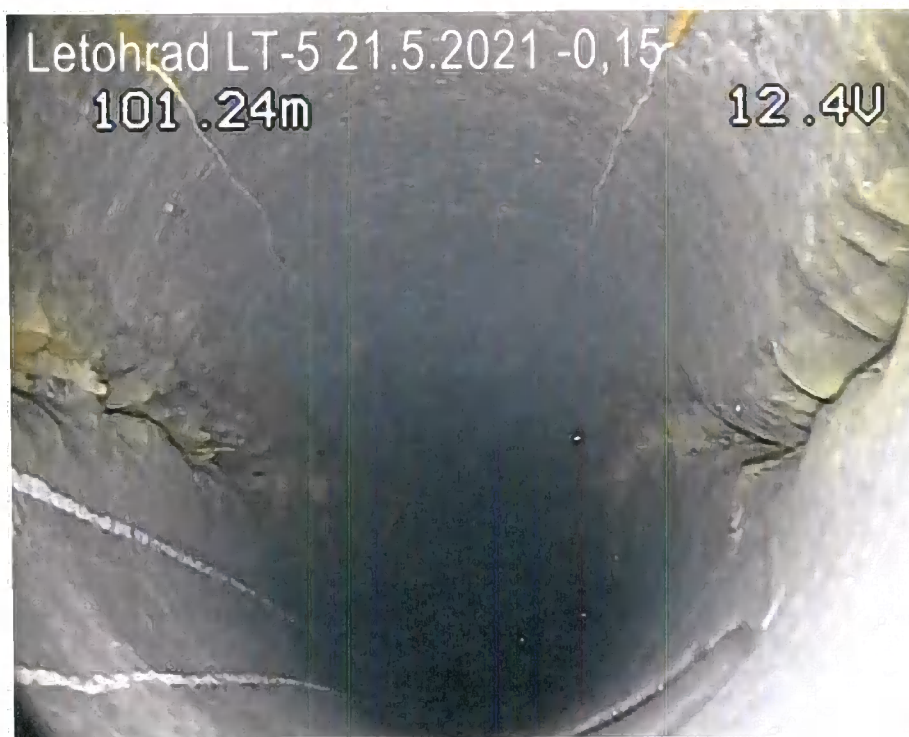
Obr. č. 22: Hlavní puklinová zóna – 101,24 m.
