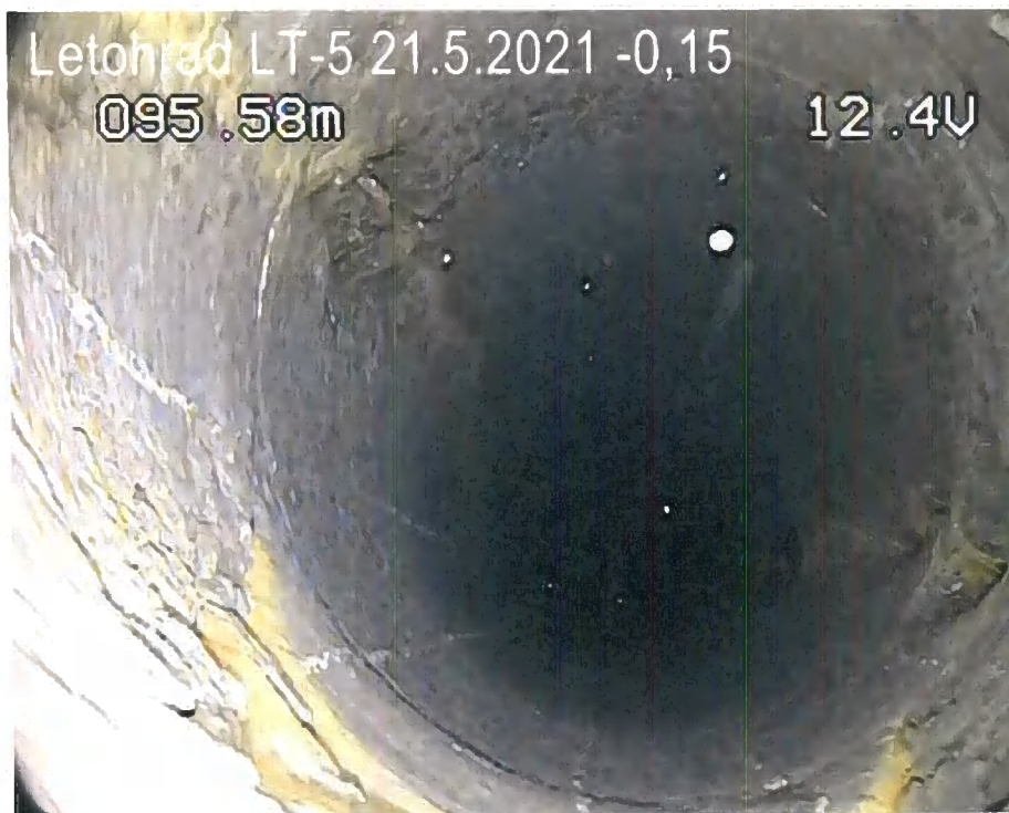
Obr. č. 21: Začátek hlavní pukliny v hloubce 95,6 m od OB.
