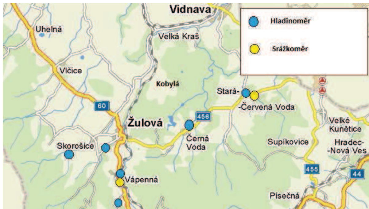
Obrázek 6 Schéma rozmístění hladinoměrů a srážkoměrů v mikroregionu Žulovsko
