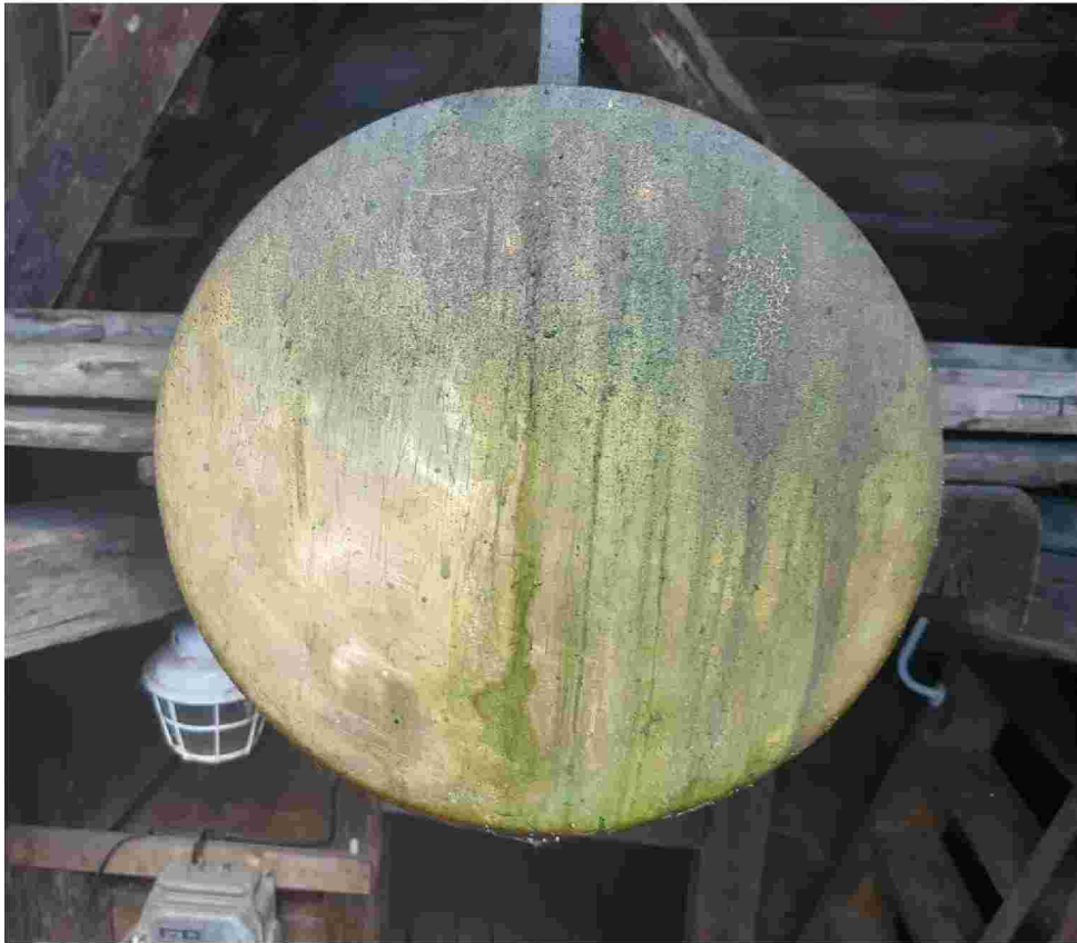
Kyvadlo, povrch je zlatený, aby byl viditelný ve vitrážovém okně radnice
