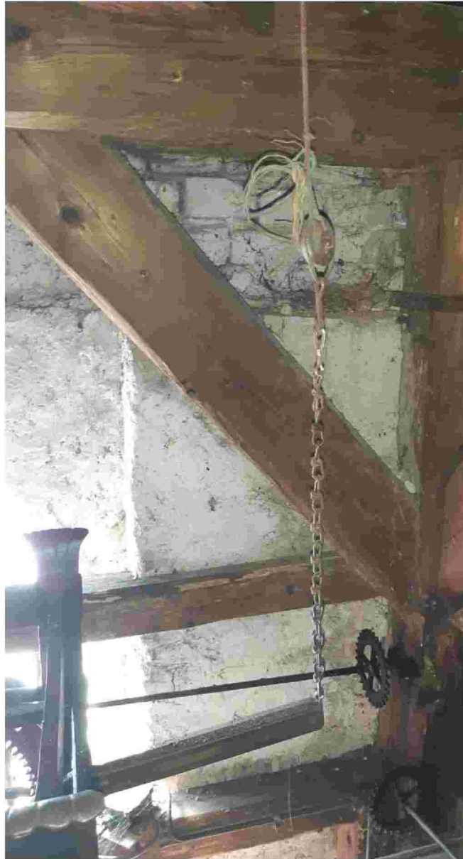
Přenos tahové síly od stroje k paličkám
