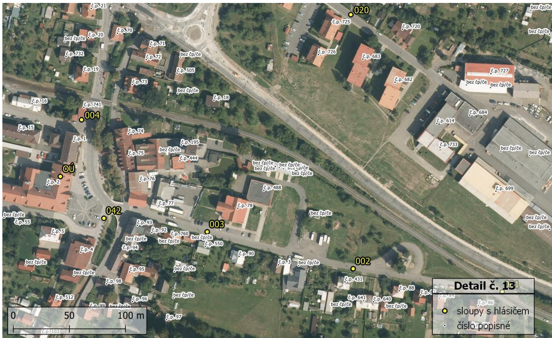
Umístění sloupů s hlásiči v obci Hovězí – detail č. 13.
